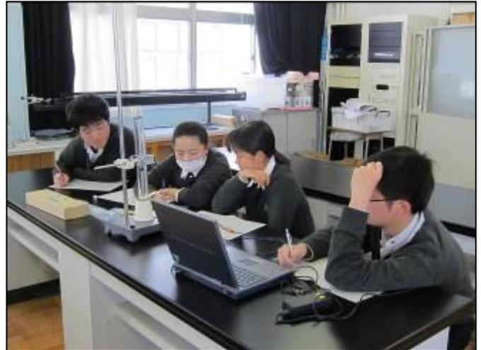
物理基礎の授業で「気柱の共鳴」の実験を行いました。落下運動（6月）、酵素の実験（7月）、力学的エネルギー保存（10月）に引き続き、今年度の最後の実験でした。これまでの実験と同様に、1班4～7名編成で実験を行いました。今回の実験の目的は、音源の振動数を変え、共鳴点を探ることによって音波の波長を求め、音速の値を計算することです。生徒たちは、ピストンを上げていながら、音源による音が大きくなる位置を自分の耳で判断するのにやや苦勞していました。ただ、何度も同じ実験を繰り返すことでコツをつかむようになり、多くのデータをとることができました。そして、各班とも波の基本式を用いてほぼ正確に音速の値を計算することができました。
