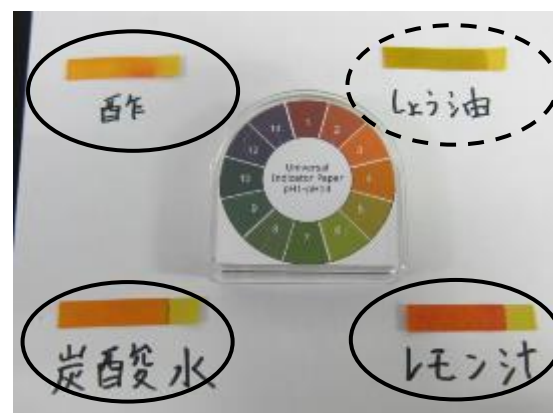
Fig.3 pH 試験紙と各物質の結果
