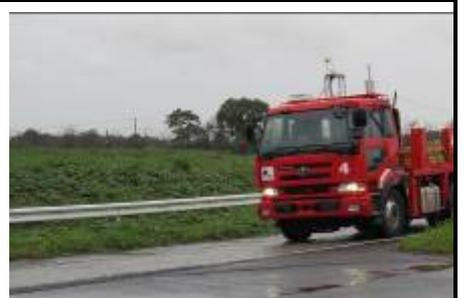
土木技術の向上を図るために設立された日本を代表する研究所で、土木に関する新しい技術開発を目的としています。今回は舗装に関する研究施設や野外の橋梁耐久実験施設を見学しました。舗装に関しては、アスファルトよりも初期投資は高いが、コンクリート舗装の方が耐久性が高く、長い視点で見ればコストは変わらないことを学び、新たな素材での排水性の高い舗装素材を実験により確かめました。外ではテストコースで舗装に付加を掛けるため、無人のトラックが 4 台、GPS 操作で走行していました。道路を見る目が変わるかも！
