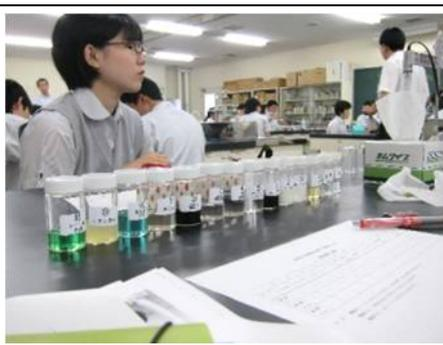
水溶液の酸性や塩基性の強さを表すpH(ピーエフ)を、身近な、食酢、石けん水、牛乳、コーヒー、しょう油、虫さされ薬、換気扇用洗剤、レモン水、トイレ用洗剤などについて測定し、測定方法を学びました。蒸留水がpH7(中性)ではない理由も学びました。
