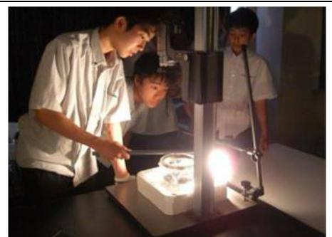
ウィルソンの霧箱実験の簡単な装置を使い、実際に放射線が線源から出る様子をビデオ撮影して観察しました。また、 $\beta$ 線源を用いて、ガイガー・ミュラー管による放射線の計測を行いました。放射線の安全教育を含め、目に見えない放射線から身を守るための方法を学ぶことができました。
