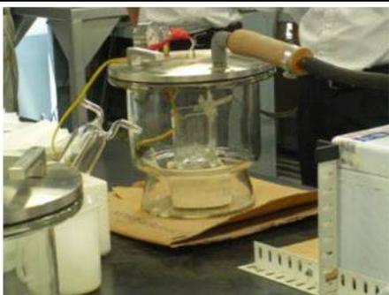
始めに真空とはどのような状態なのか、どのようにして真空にするのか、などの講義を受けました。実験で用いるポンプにも様々な種類があり、その種類により真空の度合いも異なることを学びました。その後、真空状態での低温沸騰、排気鐘による真空中での音の伝わり方の観測ができました。
