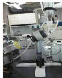
↑コレステロールを結晶化させる減圧濃縮機
