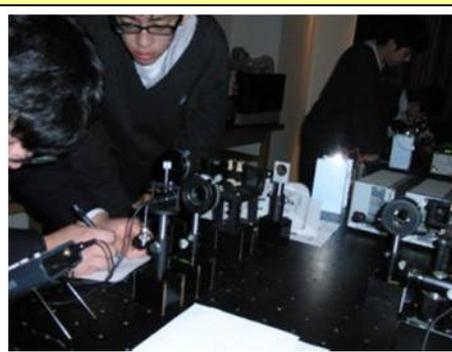
①LEDの偏光特性を調べばほぼ無偏光であることを確認。②①の系で3Dメガネの偏光子の角度を変えてLEDの透過光強度を調べることで左右のメガネの偏光特性を測定。③②の系で偏光子と3Dメガネの間に $1/2\lambda$ 板を挿入し透過光強度を測定。④半導体レーザーの偏光特性がほぼ直線偏光であることを確認。以上の実験を通して、3Dメガネを使った3Dテレビの仕組みを学ぶことが出来ました。
